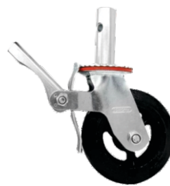
Cód.: 041 Roda para Andaime 6" Emborrachado 150mm para andaime tubular Diâmetro da Roda 6" (Pol): 152,4mm Largura da Roda 2" (Pol): 50,8mm Diâmetro do tubo (espiga): 32mm Comprimento do tubo (espiga): 150mm Cobertura da Roda: Emborrachada Cubo da Roda: Ferro fundido pintado em preto Roda para Andaime com Trava (freio) Com graxeira para lubrificação
