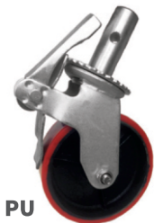
Cód.: 041 Roda para Andaime 6" Emborrachado 150mm para andaime tubular Diâmetro da Roda 6" (Pol): 152,4mm Largura da Roda 2" (Pol): 50,8mm Diâmetro do tubo (espiga): 32mm Comprimento do tubo (espiga): 150mm Cobertura da Roda: Emborrachada Cubo da Roda: Ferro fundido pintado em preto Roda para Andaime com Trava (freio) Com graxeira para lubrificação
